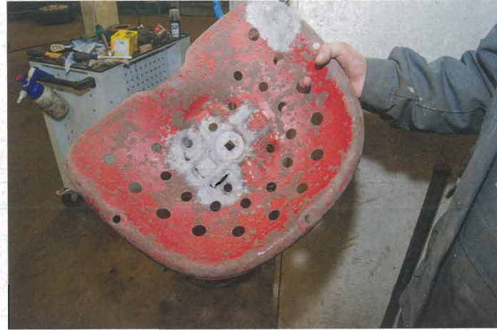
Nach wenigen Minuten Sandstrahlen ist der Sitz im Bereich der Sitzverschraubung rost- und lackfrei.
