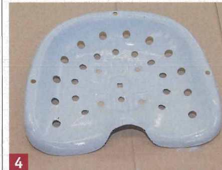
4 Bevor der Sitz des Eicher ED 22 seinen Farbanstrich bekommt, muss er ein paar Minuten trocknen.
