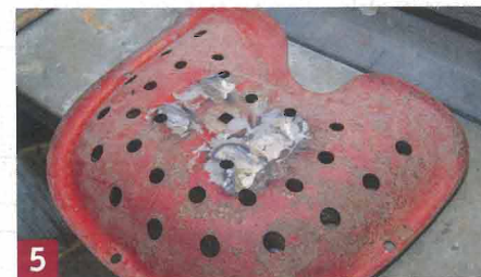
5 Nach dem Schleifen kontrolliert Krzysztof nochmals sorgsam das Ergebnis seiner Arbeit.
