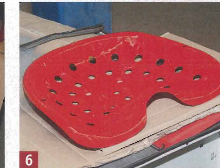
6 Noch glänzt der Lack feucht. In gut 24 Stunden ist er getrocknet. Wer will, kann dann den Lack noch polieren.
