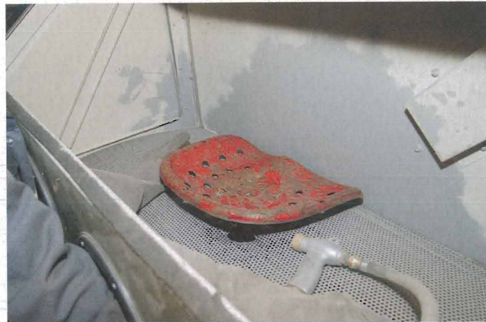
Krzysztof hat den Sitz in die Sandstrahlbox gelegt, um ihn im Bereich der Sitzverschraubung sandzustrahlen.
