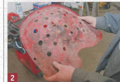
2 Nach der Demontage des Sitzes zeigen sich im Bereich seiner Verschraubung starke Rostlöcher.
