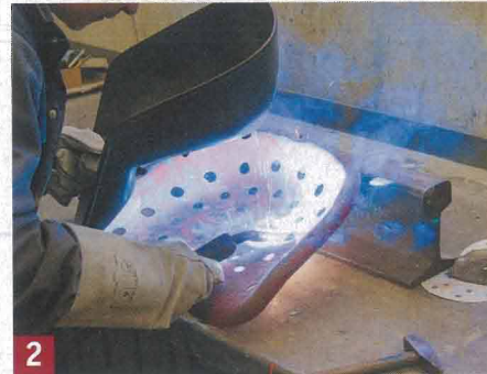
2 Das Zuschweißen von Löchern setzt Erfahrung voraus. Wichtig ist die richtige Einstellung des Schweißgerätes.
