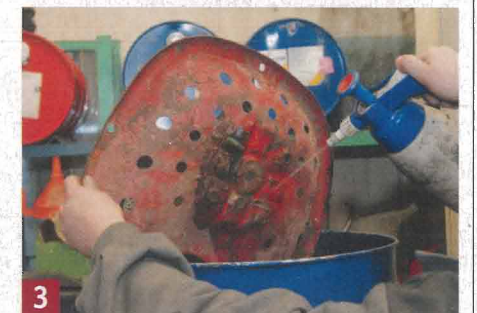
3 Bevor am Sitz gearbeitet werden kann, muss er zuerst gründlich von Fett und Schmutz befreit werden.
