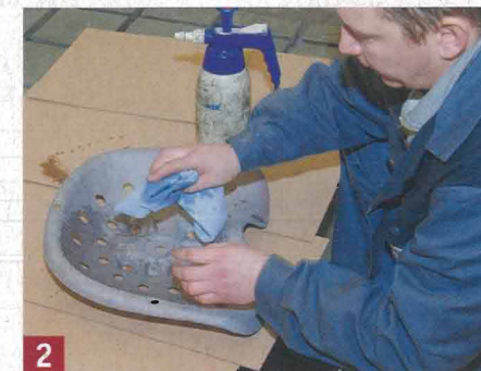
2 Fett und Strahlreste müssen sorgfältig abgewaschen werden, um einen optimalen Lackiergrund zu erreichen.
