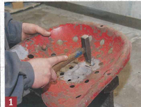
1 Mit der Keilseite des Schlosserhammers egalisiert Krzysztof vorsichtig das Blech um die Rostlöcher.
