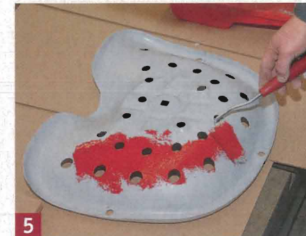
5 Das Grundrot des Farbauftrages wird verdünnt aufgerollert, damit die Farbe besser verlaufen kann.
