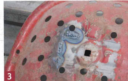
3 Auch von der Rückseite ist die Schweißung gelungen. Nichts vom Material des Sitzes ist weggeschmolzen.
