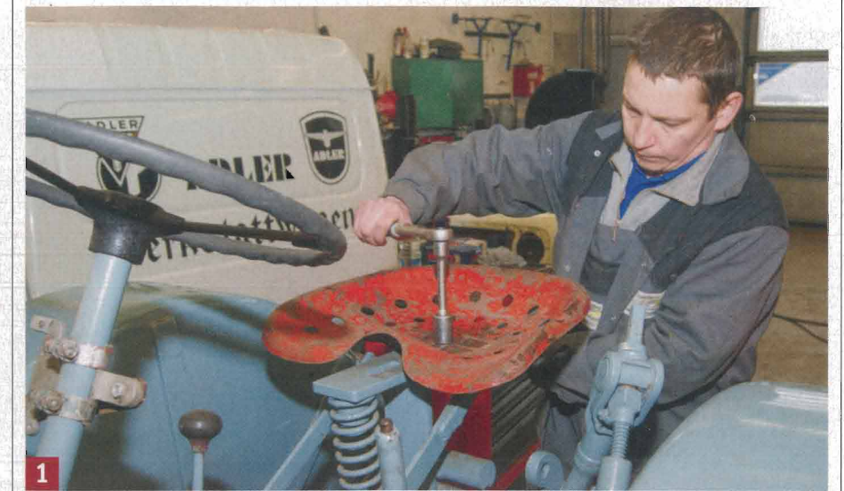
1 Mit der Keilseite des Schlosserhammers egalisiert Krzysztof Sikorski vorsichtig das Blech um die Rostlöcher. Bevor er den Sitz restauriert, muss er ihn demontieren.
