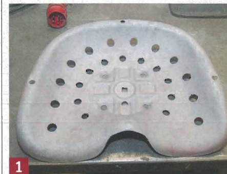
1 Der fertig gestrahlte Sitz darf keine Spuren von Rost oder Lack mehr haben. Sonst muss nachgearbeitet werden.
