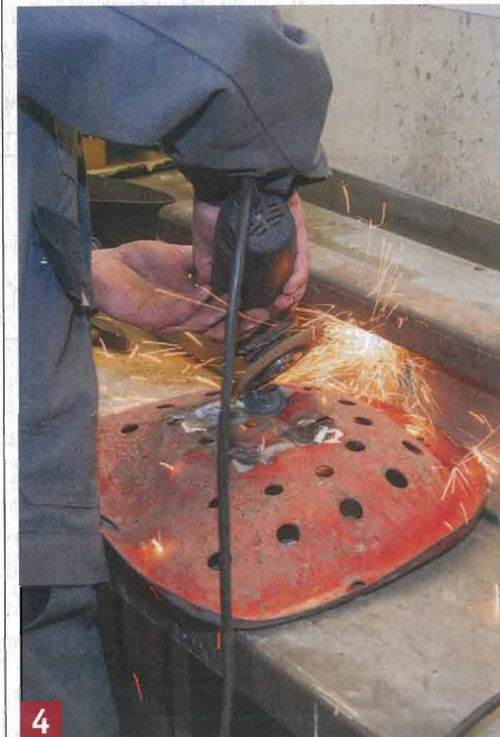
4 Mit dem Winkelschleifer und einer 180er-Schleifscheibe wird die Schweißstelle von Krzysztof vorsichtig „geputzt“.
